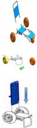
**Étape 2:** Insérez les roues sur l'axe du châssis comme indiqué sur le croquis. Utilisez le trou spécial sur le moyeu, préalablement aligné avec le trou présent sur l'axe du châssis et insérez l'attache. Assurez-vous que chaque attache de roue est correctement verrouillée sur le moyeu.
